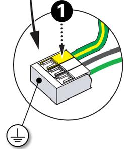
1 Insérer le fil **non dénudé** jusqu'au fond du bornier.
